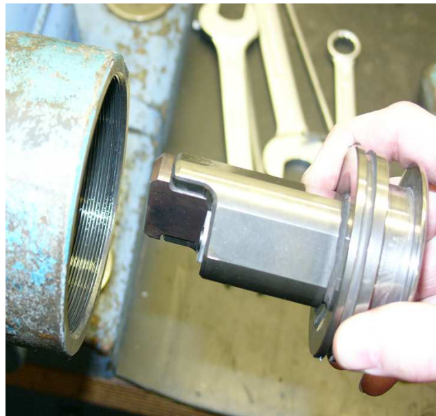
Bild 8.22: Einbauposition Kolben mit Stößelmesser
