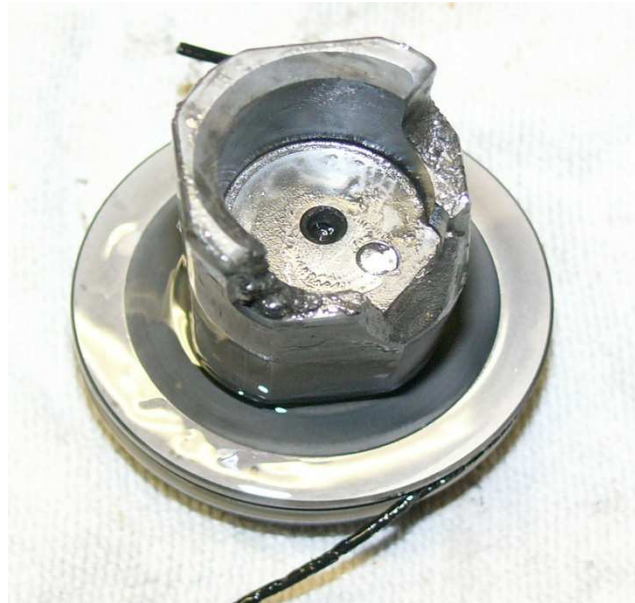
Bild 8.17: Kolben beschädigt (Vorderansicht)
