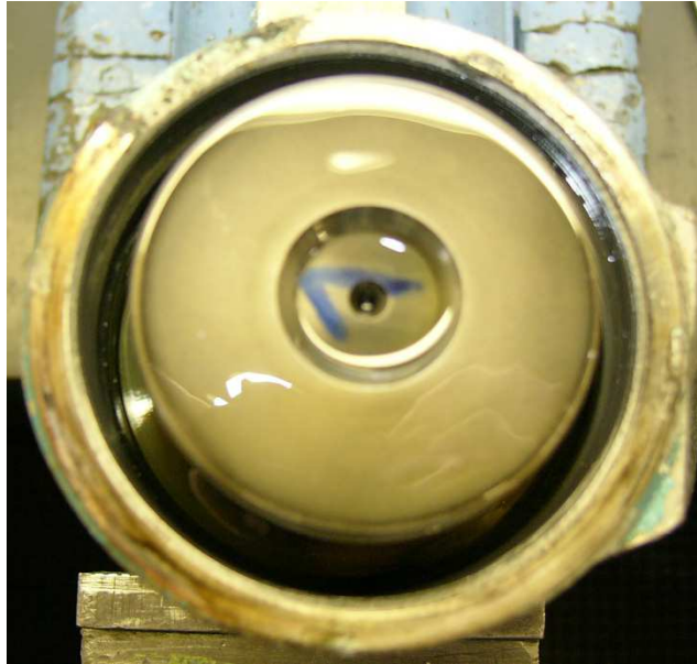
Bild 8.15: Kolben mit Ölfilm in eingebautem Zustand.
