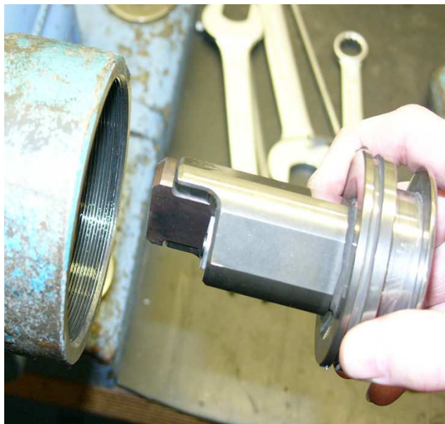
Bild 8.16: Kolben in ausgebautem Zustand.
