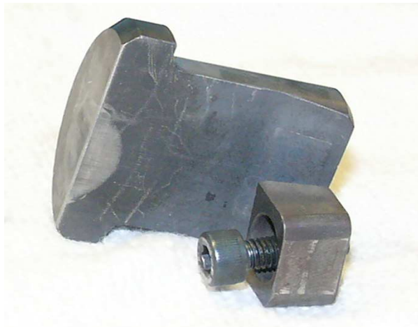
Bild 8.4: Stößelmesser mit Keilstück
