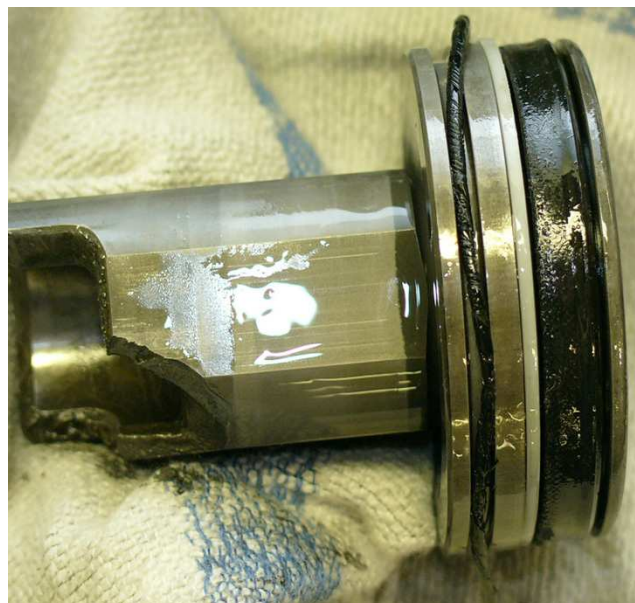
Bild 8.18: Kolben beschädigt (Seitenansicht)
