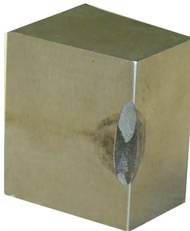
Bild 8.5: Schermesser mit Beschädigung
